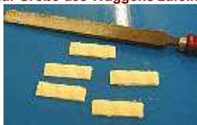
1. Schritt: auf Größe des Waggons zufeilen
